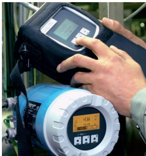
Рисунок 4.1 – Устройство имитационно-поверочное FieldCheck
